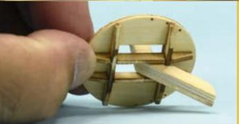
10 Подготовленную в предыдущем шаге кницу нужно приклеить к одной из внутренних сторон марсовой площадки. При этом выступ кницы должен войти в отверстие площадки (см. фотографию). Таким образом вы закончили сборку марса ТМ1, который в дальнейшем будет установлен на бушприте модели.
